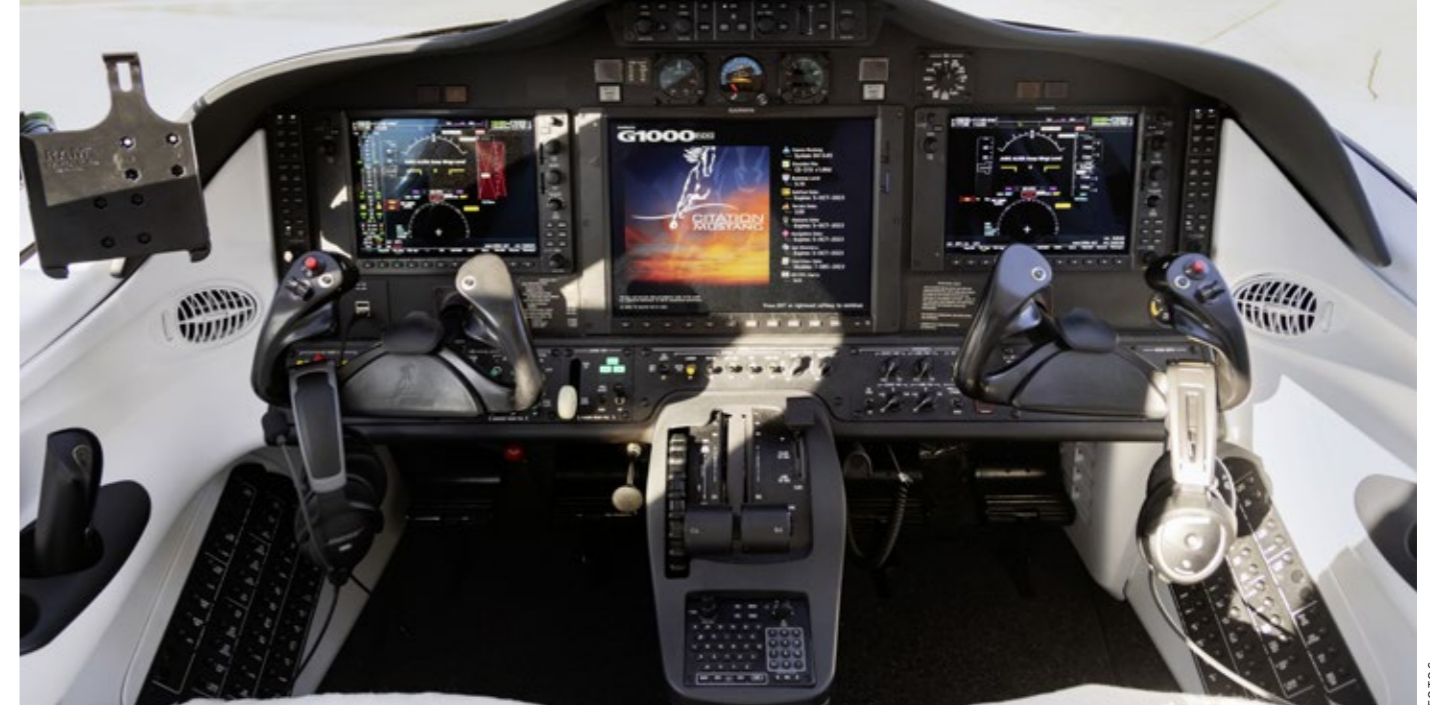
Wichtiges Upgrade Textron selbst bietet die Aufrüstung der ursprünglichen G1000-Avionik zum aktuellen G1000NXi-Panel an
