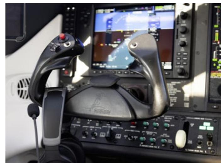
Platz an den Beinen Die Mustang hat keine Steuersäule, sondern ein Horn, das aus dem Panel ragt
