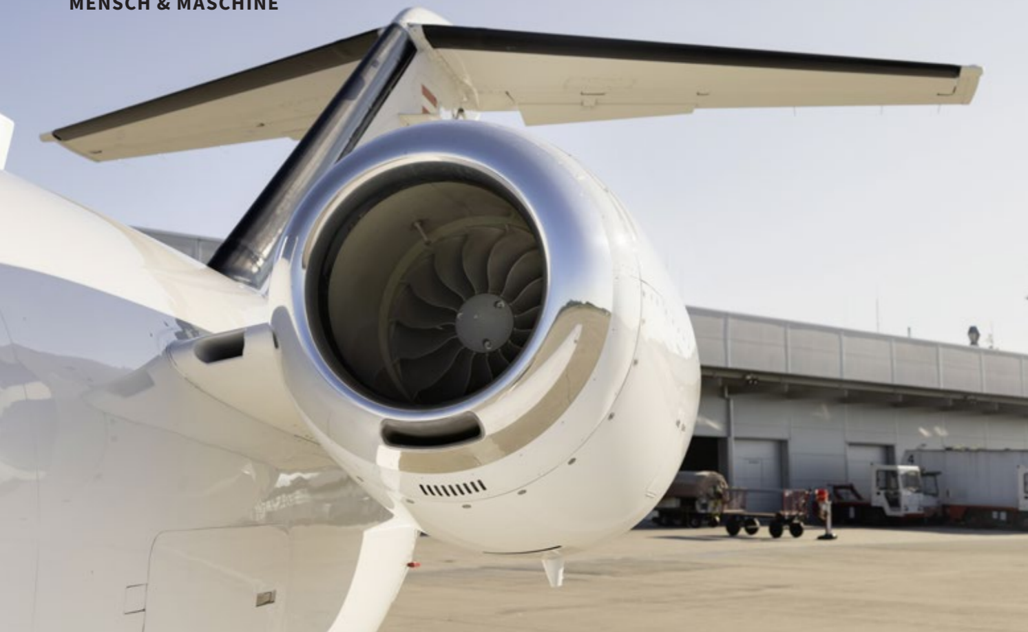
Quantensprung Die Triebwerksfamilie PW600 von Pratt & Whitney wurde speziell für kleine Jets entwickelt. Erst damit und mit ähnlichen Konkurrenzprodukten wurden die Very Light Jets möglich
