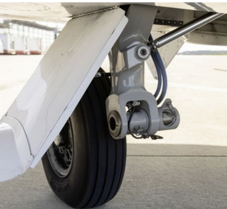
Gute Bremsen Die Mustang wurde serienmäßig mit Anti-Blockier-System geliefert. Weil sie keinen Umkehrschub hat, kommt den Bremsen bei der Landung große Bedeutung zu
