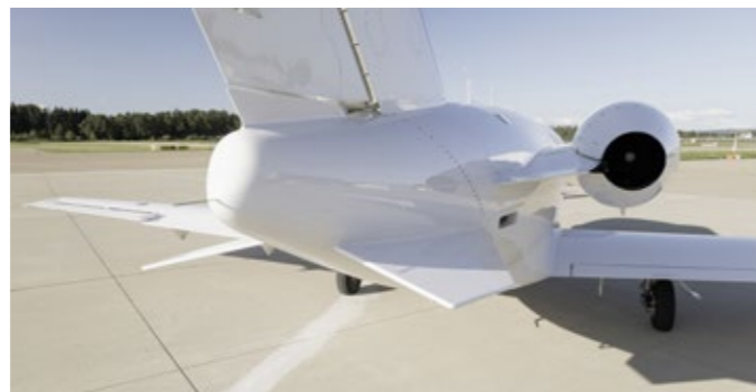
Luftführung am Heck Luftleitbleche, auf Englisch »strakes«, kontrollieren bei vielen schnelleren Flugzeugen den Luftstrom am Heck
